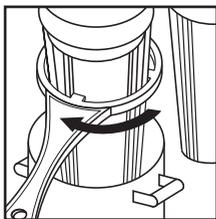
1. Перекройте подачу воды к фильтру, подставьте емкость объемом не менее литра под корпус картриджа, отверните корпус специальным ключом.
