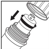
4. Вставьте обратноосмотическую мембрану в корпус, стороной с двумя резиновыми кольцами вперед.
