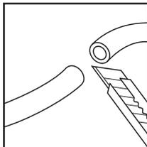
7. Разрежьте трубку (шланг) на четыре части и соедините ими детали фильтра в соответствии с принципиальной схемой (длина частей выбирается на месте).
