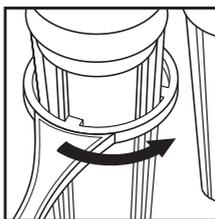
5. Наверните корпус с картриджем на крышку рукой до упора, а затем затяните с помощью ключа. Повторите процедуру 1-5 для оставшихся картриджей.
