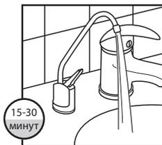
10. Закройте кран (10) на накопительном баке, откройте кран для чистой воды (14), откройте подачу воды краном (1), включите вилку в сеть электропитания 220В и нажмите кнопку с надписью WASHING на электронном контроллере (17). Это требуется для промывки картриджей от угольной пыли. Подробно процедура первичной промывки описана в разделе «Первоначальная промывка».
