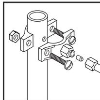
6. Просверлите отверстие в трубе сливного сифона и установите дренажную муфту.
