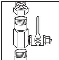
1. Перекройте доступ воды к мойке, установите в водопроводную магистраль холодной воды тройник с шаровым краном.
